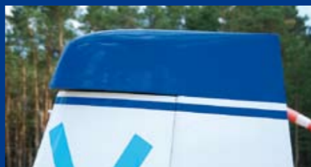
DIE LACKIERUNG kaschiert geschickt das große Seitenruderhorn.
