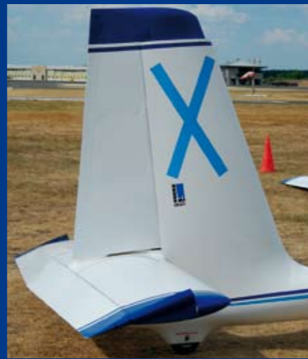
DIE LACKIERUNG kaschiert geschickt das große Seitenruderhorn.
