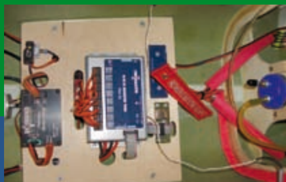
Der Weatronic-Empfänger und die Steuereinheit für das elektrische Einziehfahrwerk.
