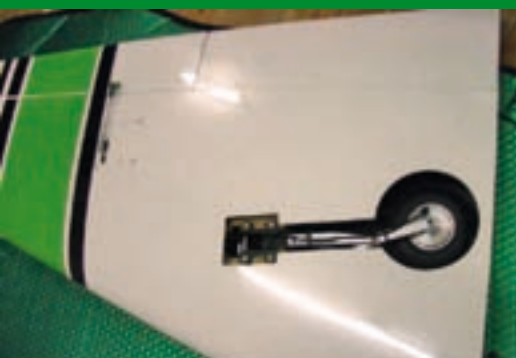
Das elektrische Einziehfahrwerk – mittlerweile sind auch elektrische Bremsen lieferbar.
